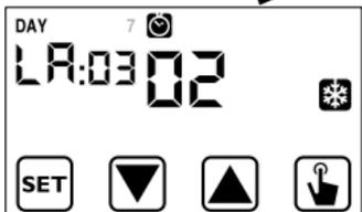
6. Una volta impostati tutti i parametri, per uscire e tornare al menù di programmazione, premere brevemente il tasto **SET**.
