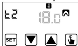
5. Viene visualizzato il valore della temperatura T3 lampeggiante. Modificare il valore con i tasti ▲ e ▼ e premere il tasto ⏏ tornare alla pagina della temperatura T1.
