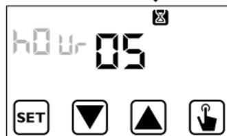
5. Una volta impostati tutti i parametri, per uscire e tornare al menù di programmazione, premere brevemente il tasto **SET**.
