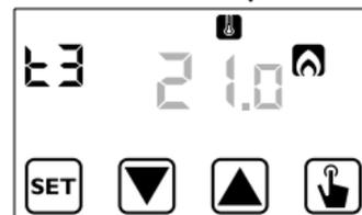
6. Una volta impostati tutti i parametri, per uscire e tornare al menù di programmazione, premere brevemente il tasto **SET**.
