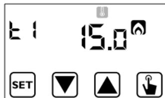
3. Viene visualizzato il valore della temperatura T1 lampeggiante. Modificare il valore con i tasti ▲ e ▼ e premere il tasto ⏏ per passare alla modifica di T2.
